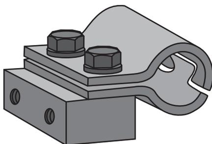
Halteklotz flach liegend montiert
