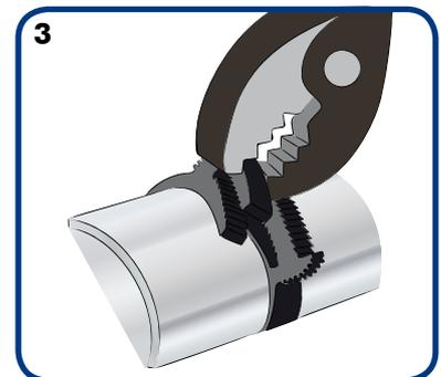
**3 |** Lösen Sie die Schelle vom Werkstück indem Sie mit einer Zange das obere Ende greifen und seitlich aus der Raste schieben.
