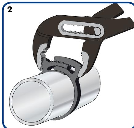
**2 |** Im zweiten Schritt sollten die beiden Enden der Schelle mit einer geeigneten Zange bis Werkstoffdurchmesser festge-
